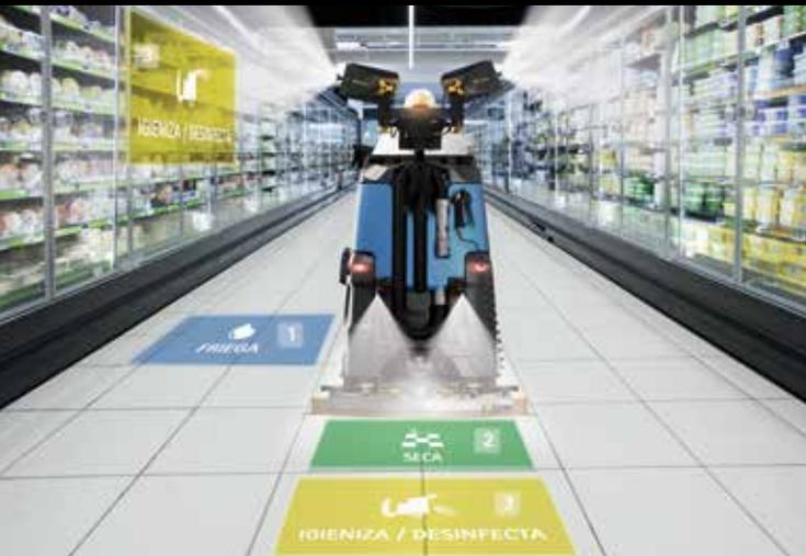
Mientras BMg Disinfecto limpia el pavimento, grupos de toberas colocadas sobre el tanque y en la base de la máquina rocían el líquido desinfectante sobre el suelo recién limpiado y sobre las paredes y los muebles hasta 3 metros de distancia y en altura. Se pueden realizar hasta 3 acciones simultáneamente en la misma operación de limpieza:
